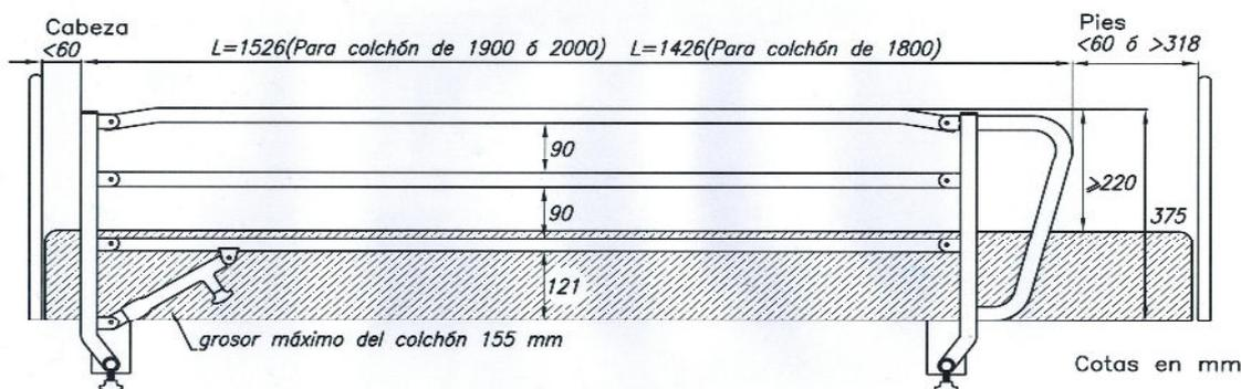
Estructura de acero con tres barras de tubo  $\text{Ø}25 \times 1.5$  mm. y asa de acero.
