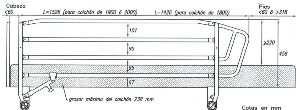
Estructura de acero con cuatro barras de tubo  $\text{Ø}25 \times 1.5$  mm. y asa de plástico termoinyectado con 15%FV.
